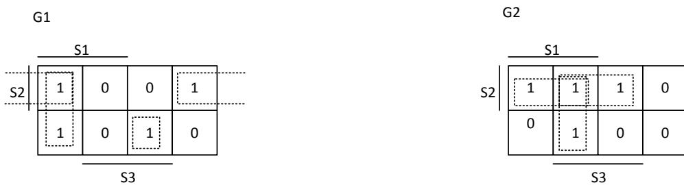
$$G_1 = S_1 \cdot \overline{S_3} + S_2 \cdot \overline{S_3} + \overline{S_1} \cdot \overline{S_2} \cdot S_3$$
