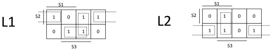
$$L_1 = S_2 \cdot \overline{S_3} + \overline{S_1} \cdot S_3 + \overline{S_2} \cdot S_3$$
