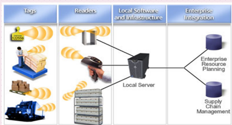
Slika 2: Delovanje tehnologije RFID
