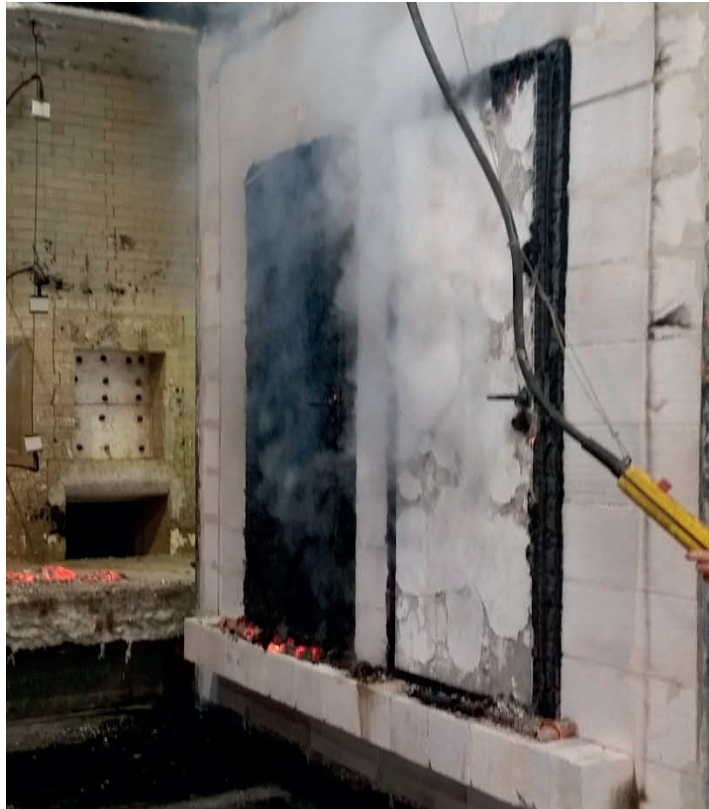
Slika 3: Izpostavljena stran vrat po preizkusu
