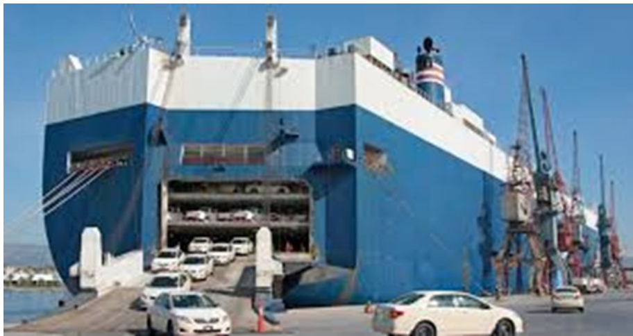
Slika 3: RO-RO ladja za prevoz avtomobilov [2]
