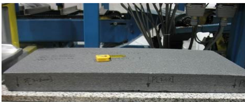
Slika 1: Merjenje ravnosti (ukrivljenosti) po dveh dneh neposredne izpostavljenosti soncu
