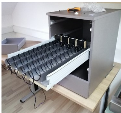
Slika 3: Predalnik, predal z vgrajenimi spiralnimi mehanizmi za izmet (levo) in optičnimi merilniki razdalje nad prvim prostorom za produkt nad vsako spiralo (desno)
