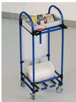
Slika 2: Voziček za pakiranje, sestavljen z elementi Creform [3]
