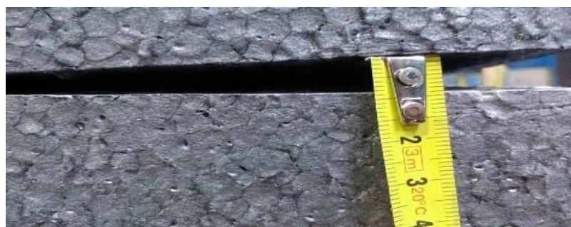
Slika 2: Ukrivljenost plošče po dveh dneh neposredne izpostavljenosti soncu
