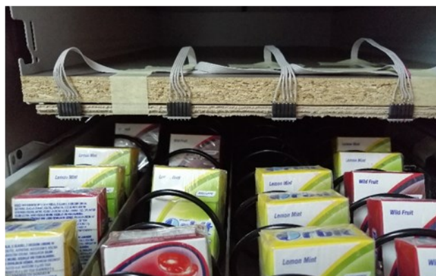
Slika 3: Predalnik, predal z vgrajenimi spiralnimi mehanizmi za izmet (levo) in optičnimi merilniki razdalje nad prvim prostorom za produkt nad vsako spiralo (desno)
