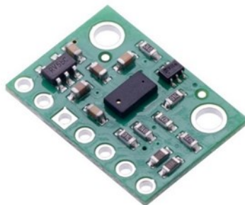
Slika 2: Optični merilnik razdalje v integrirani izvedbi s senzorjem in merilnim modulom
